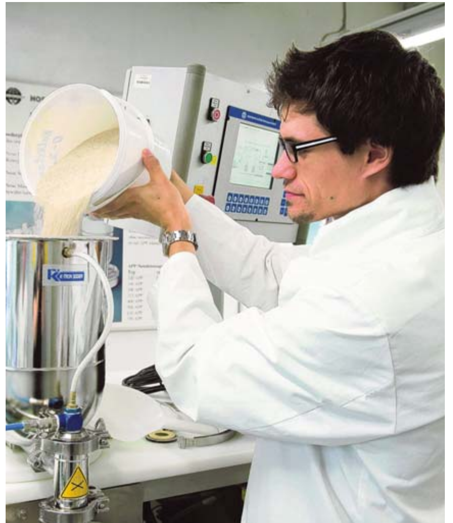
Zur forschungsstarken Hochschule gehören Absolventen wie Kai-Nino Streicher. Hier füllt er im Labor für Verfahrenstechnik Kalkstein in eine sogenannte Multiprozessanlage. Damit können Feststoffe gezielt bis zu wenigen Mikrometern fein gemahlen werden. BILD: HTWG
